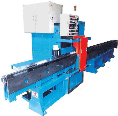
このほど導入したのは、直径150ミリまでの棒材に対応する自動切断機「KBS-150」（山本機械産業製）。主に銅・銅合金の丸棒
